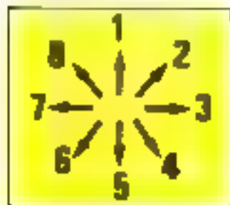
Fig. 2. Les codes des huit directions possibles d'un joystick.
